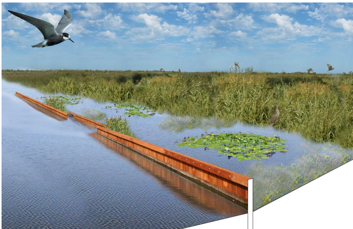
Figuur 5-4 Visualisatie 'het water in': Houten Damwand
